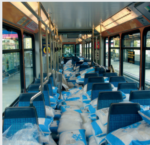
Abbildung 2: Lastfahrt für die Energieversorgung; 20 Tonnen Zuladung entspricht rund 250 Fahrgästen
