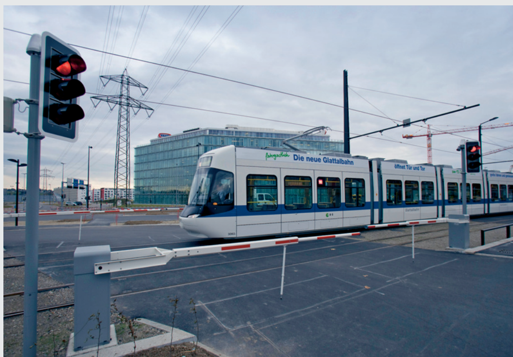
Abbildung 2: Kreuzung Schiene–Strasse, durch ein Lichtsignal geregelt (Typ 3.2)
