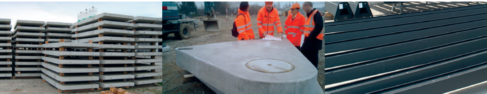
Abbildung 4: Serienfertigungen Perronbetonfertigteile, Perronkopfbetonfertigteile und Fahrleitungsmasten
