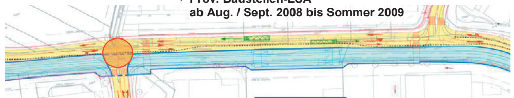
Abbildung 13: Provisorische Baustellen-LSA am Knoten Hertistrasse / Weststrasse
